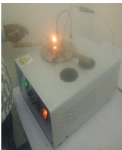
(O) Flash point, fire point. Pour point and cloud point determination
