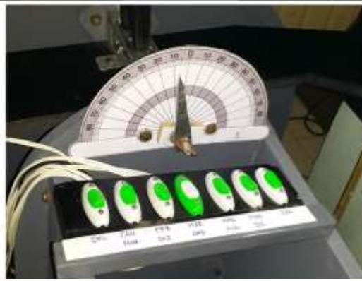
Switches and latitude angle indicator
