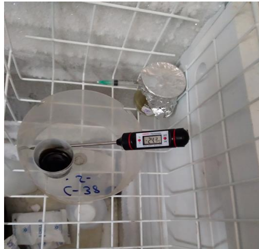
Pour point determination
