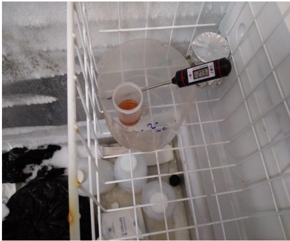
Pour point determination
