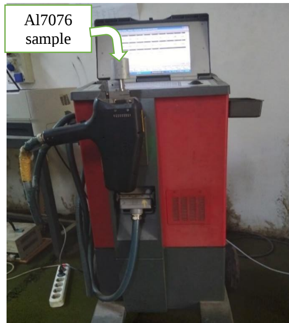
Fig. 3.2. SPECTROTEST TXCO2 Machine
