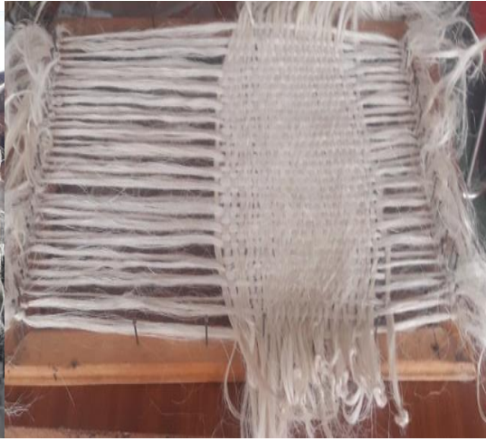
(d) Weaving at 0^{\circ}/90^{\circ} fiber
